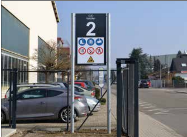
Hinweisschild 500 x 1.000 mm mit verzinkten Standrohren
